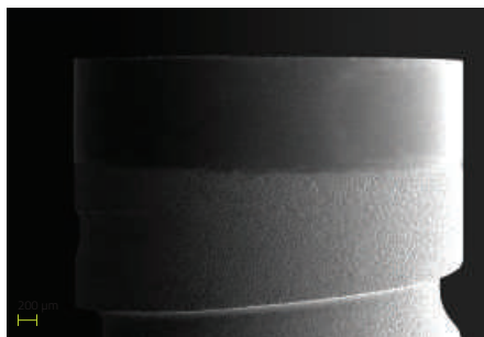
INGRANDIMENTO -65 X Immagini al microscopio elettronico di superfici HBS®
